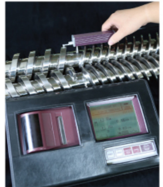
Screw roughness test / 螺桿表面粗度測量
